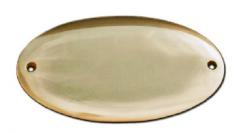
Targa per porta in ottone modello 611, realizzata in pressofusione con ottone spessore 2mm, lucida, disponibile in tre varianti, 123x65x5mm con parte centrale in piano, 130x75x5mm con parte centrale bombata oppure 150x90x5mm con parte centrale bombata. Provvista di due fori per il fissaggio tramite viti.
