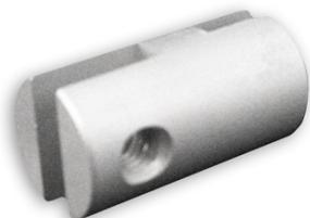
Elemento in alluminio anodizzato utile a bloccare lateralmente le tasche di plexiglass, provvisto di due grani, uno per il bloccaggio su filo all'altezza desiderata ed uno per il bloccaggio della tasca.
